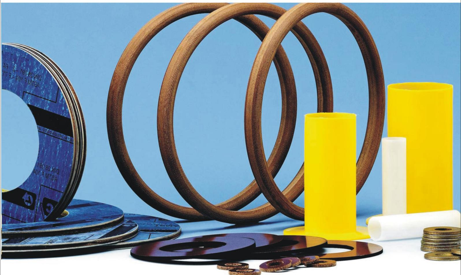
Se trata de un conjunto de piezas cuya función es aislar eléctricamente bridas de cañerías del pasaje de corrientes extrañas, evitando la corrosión y prolongando por muchos años su vida útil.
